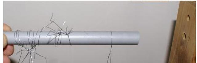
Une fois les attaches réalisées, le fil est enlevé et les liens restent sur les tubes creux.
