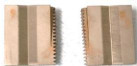
La mâchoire supérieure est équipée de 2 mors en V permettant de maintenir la tige pour les diamètre supérieur à 4,00 mm
