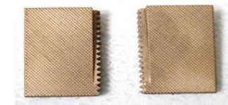
La mâchoire inférieure est équipée de 2 mors pyramidaux permettant de maintenir le crochet dans lequel sera maintenu la boucle à tester
