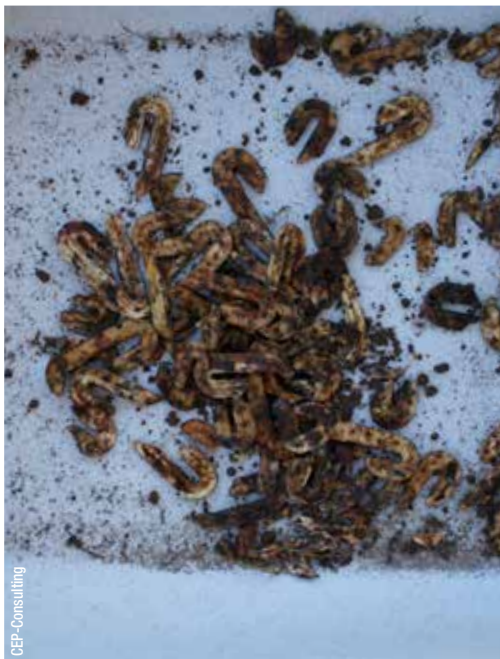
Etat de deux types d'agrafes à la fin du protocole de test.
