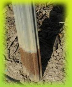
Ici un piquet avec une épaisseur initiale de zinc de 24 microns. Au bout de 15 ans, la rouille commence à attaquer l'acier. Son remplacement est proche.
