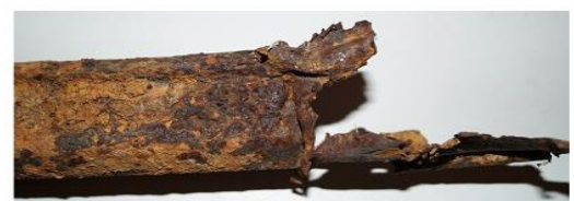
Rouille d'un piquet profilé
