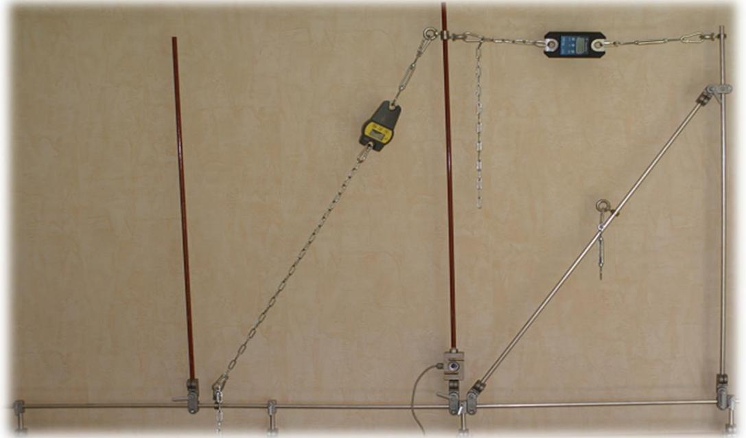
En mettant au point ce 1° simulateur, on reproduit à l'échelle n'importe quel mode d'installation, de la plus simple à la plus complexe, en mesurant les efforts et en modifiant le mode de pose pour optimiser son installation.
