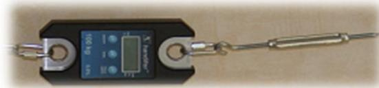
La base du piquet de tête est reliée à un capteur externe qui est lui-même relié à un dynamomètre. Ce dispositif permet de mesurer l'effort au niveau du piquet.
