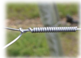
Épissure réalisée avec une clé "cuillère"
