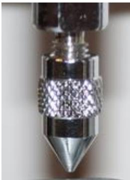
A la base du capteur externe, il est installé une tête conique qui permet d'appuyer sur la partie souhaitée du linguet.
