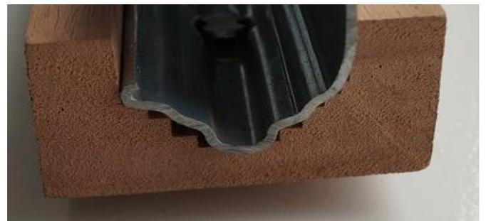
Pour chaque modèle de profilé, il est réalisé un gabarit permettant maintenir le profilé vertical sans risque de déformation.
