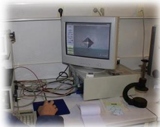
Appareil de micro dureté
