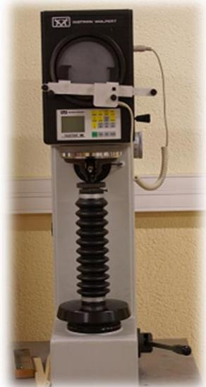
$\leq$  Appareil pour mesure dureté BRINELL
