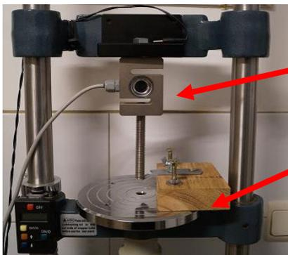
Vue du capteur externe + tige filetée inox 105 mm et diamètre 12 mm assurant la compression sur la pièce.
